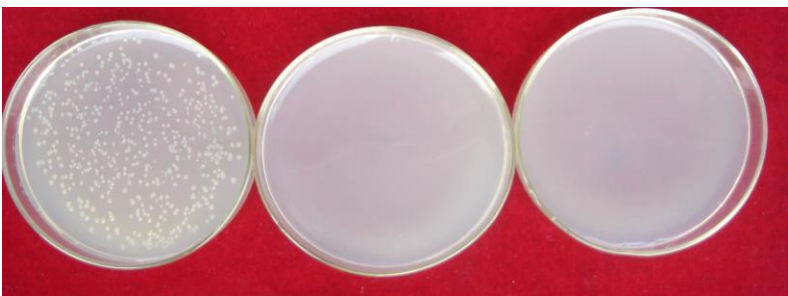
细菌与不锈钢接触后的培养情况,左:对照不锈钢,中:铁素体抗菌不锈钢,右:奥氏体抗菌不锈钢
